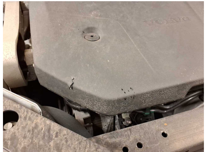
Beschädigung 2: Motor: Motorabdeckung - Marderschaden - erneuern
