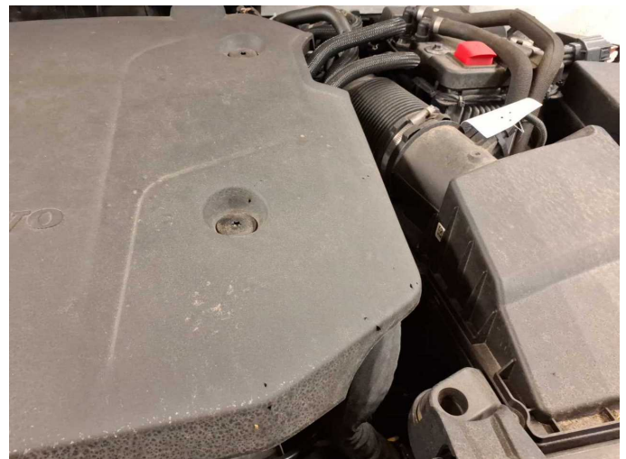
Beschädigung 2: Motor: Motorabdeckung - Marderschaden - erneuern
