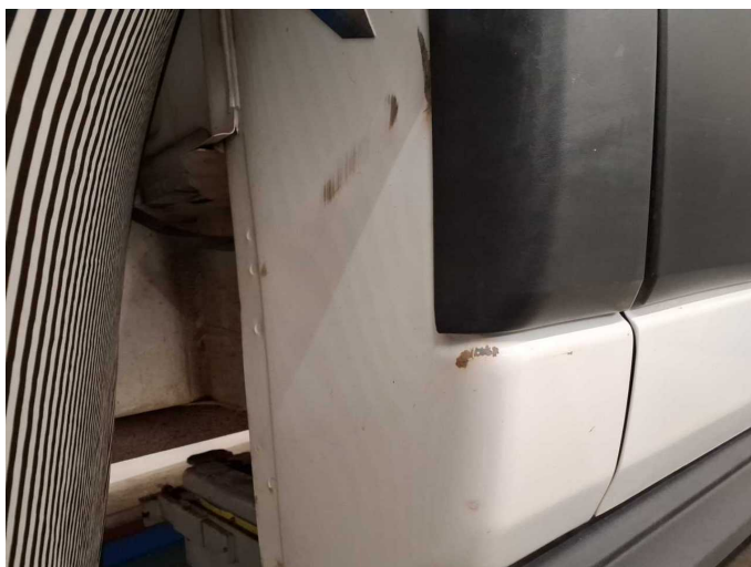
Beschädigung 15: Karosserie: C-Säule rechts - Delle / Lackschaden - instandsetzen und lackieren
