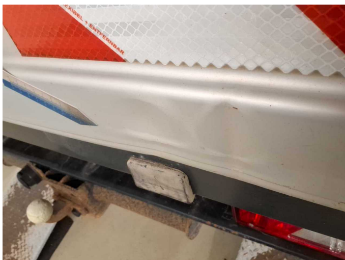
Beschädigung 21: Sonstiges: Sonstiges (Bordwandklappe hinten) - verformt - erneuern
