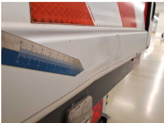
Beschädigung 21: Sonstiges: Sonstiges (Bordwandklappe hinten) - verformt - erneuern
