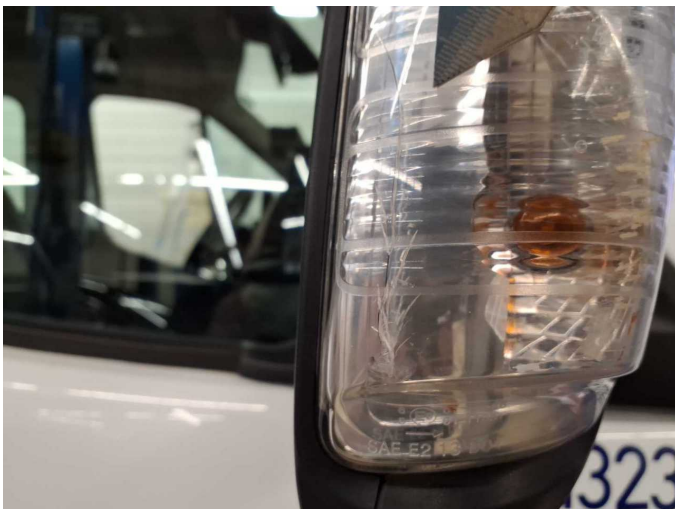
Beschädigung 4: Blinkleuchte: Spiegel rechts - gebrochen / gerissen - erneuern
