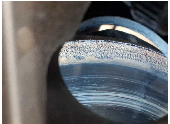
Beschädigung 17: Bremsanlage: Bremsscheiben und Beläge hinten (Tragbild) - Korrosion - erneuern
