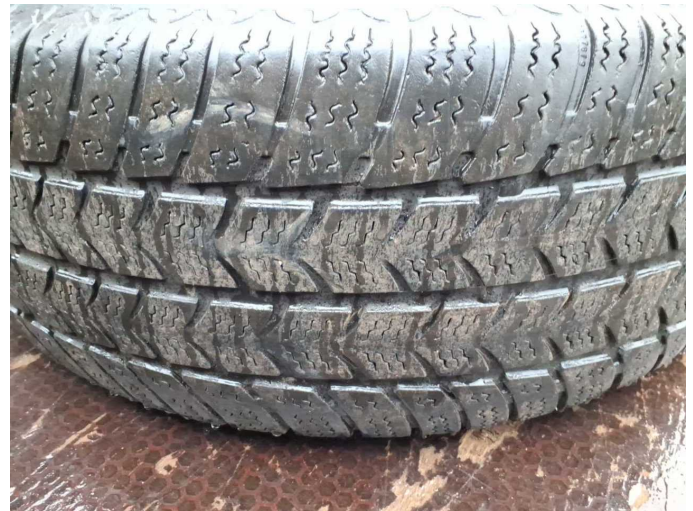
Beschädigung 14: 2.Radsatz: 2 Reifen - verschlissen - erneuern
