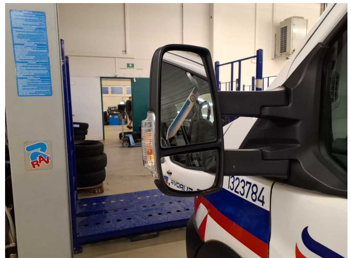
Beschädigung 5: Außenspiegel links: Spiegelglas - gebrochen / gerissen - erneuern
