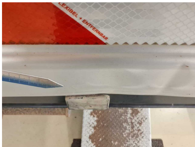
Beschädigung 21: Sonstiges: Sonstiges (Bordwandklappe hinten) - verformt - erneuern
