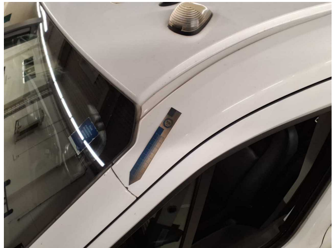
Beschädigung 9: Fahrzeugdach: Dachholm links - Kratzer - Smart Repair
