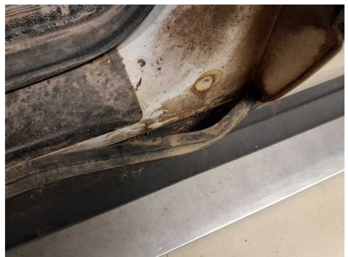
Beschädigung 2: Tür vorn links: Türdichtung (unten) - gebrochen / gerissen - erneuern
