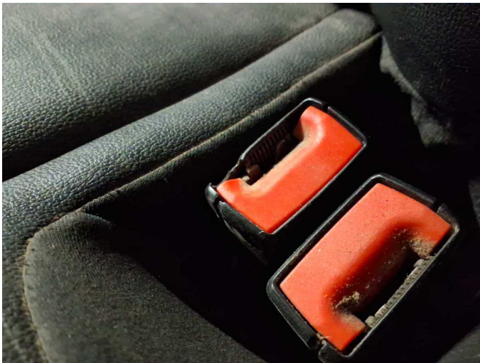
Beschädigung 3: Gurtsystem hinten: Gurtschloss hinten Mitte (+ links) - gebrochen / gerissen - erneuern
