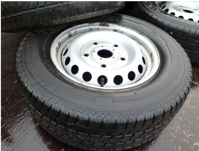
Beschädigung 14: 2.Radsatz: 2 Reifen - verschlissen - erneuern
