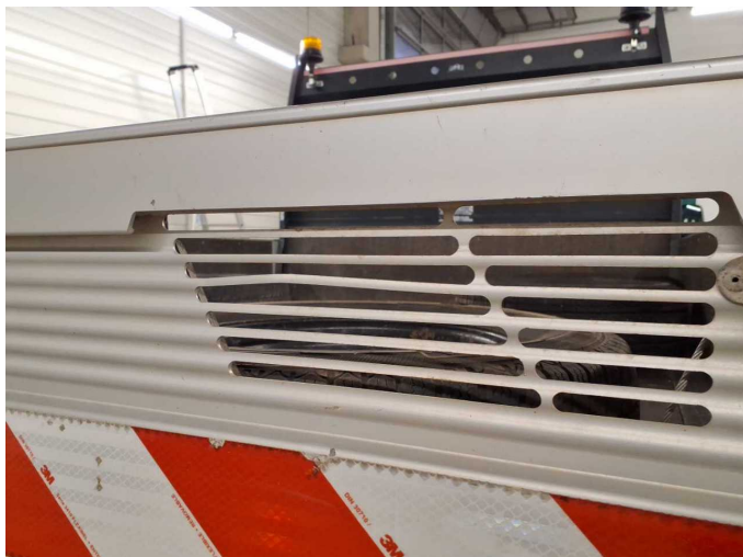
Beschädigung 21: Sonstiges: Sonstiges (Bordwandklappe hinten) - verformt - erneuern
