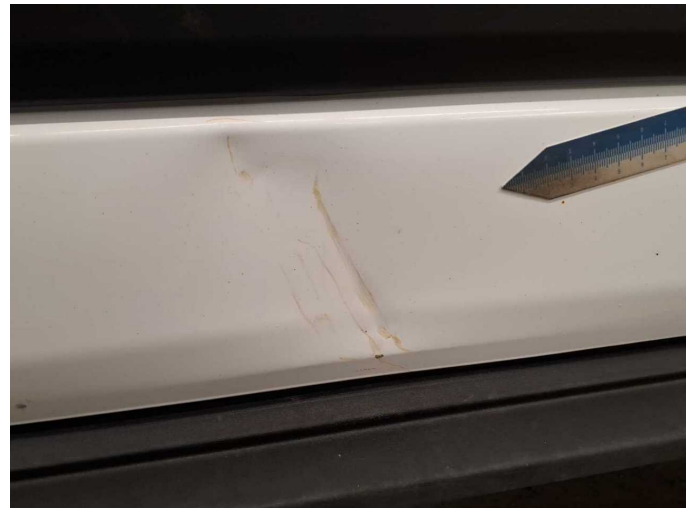
Beschädigung 18: Tür hinten rechts: Tür - Delle / Lackschaden - instandsetzen und lackieren
