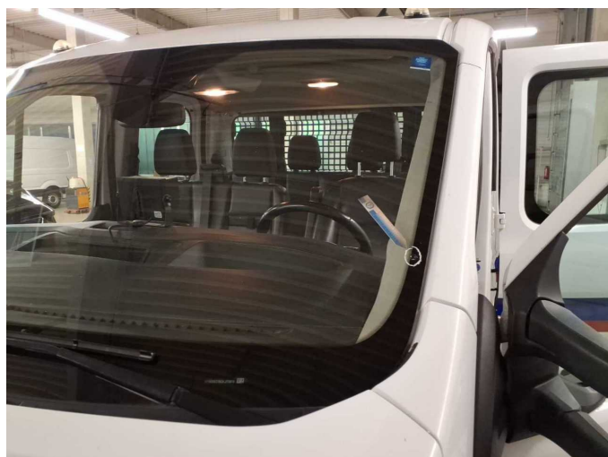
Beschädigung 22: Verglasung: Frontscheibe mit Spurhalteassistent - Steinschlag - erneuern
