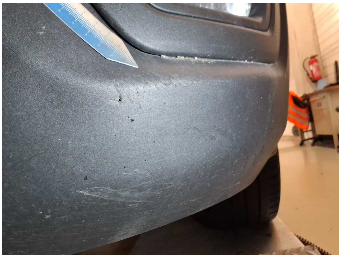
Beschädigung 13: Stossfänger vorn: Stossfänger vorn (unlackiert) (Unterteil) - verkratzt / verschürft - Smart Repair
