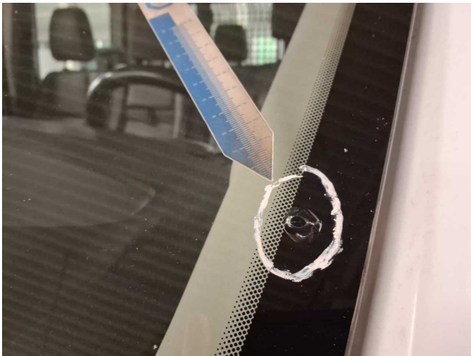
Beschädigung 22: Verglasung: Frontscheibe mit Spurhalteassistent - Steinschlag - erneuern
