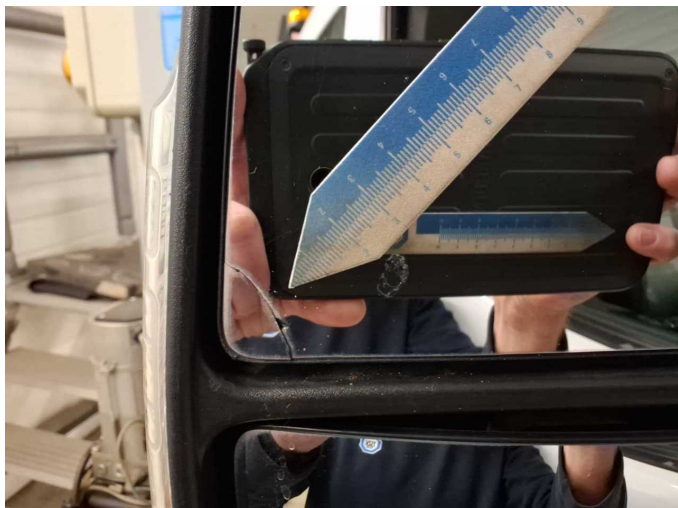
Beschädigung 5: Außenspiegel links: Spiegelglas - gebrochen / gerissen - erneuern
