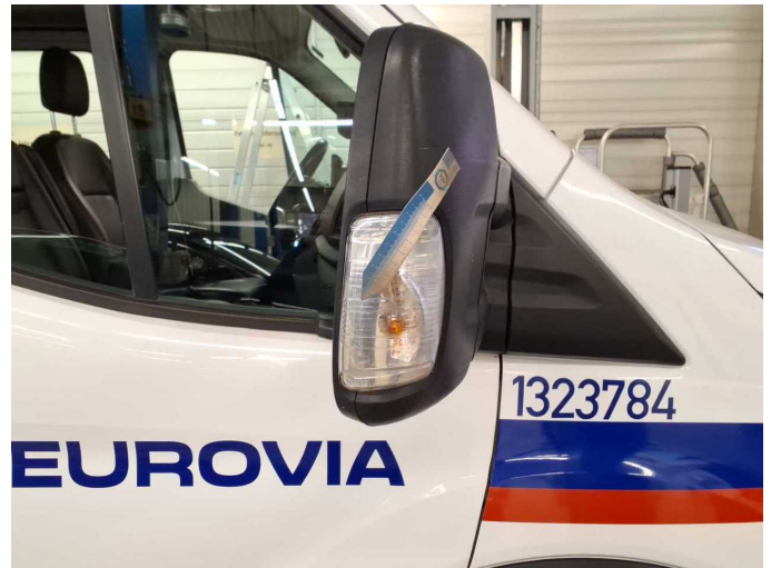
Beschädigung 4: Blinkleuchte: Spiegel rechts - gebrochen / gerissen - erneuern
