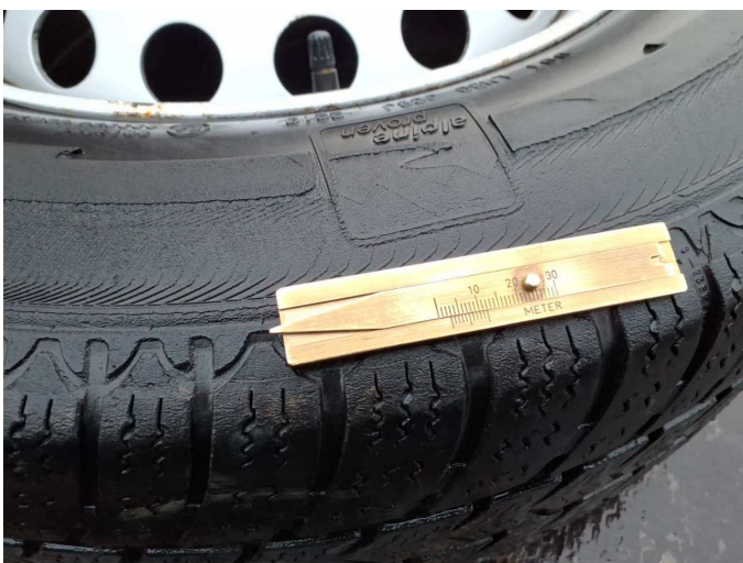
Beschädigung 14: 2.Radsatz: 2 Reifen - verschlissen - erneuern
