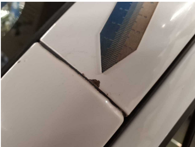
Beschädigung 9: Fahrzeugdach: Dachholm links - Kratzer - Smart Repair
