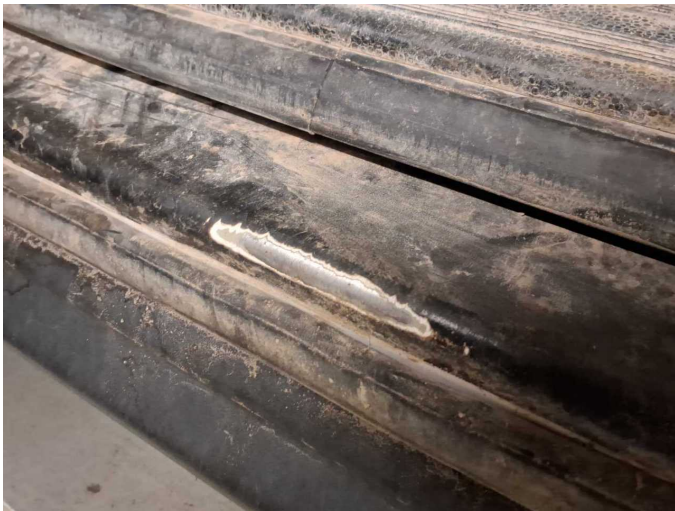
Beschädigung 8: Schweller links: Einstieg - verkratzt / verschürft - Smart Repair
