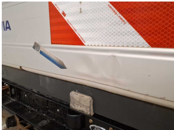
Beschädigung 21: Sonstiges: Sonstiges (Bordwandklappe hinten) - verformt - erneuern
