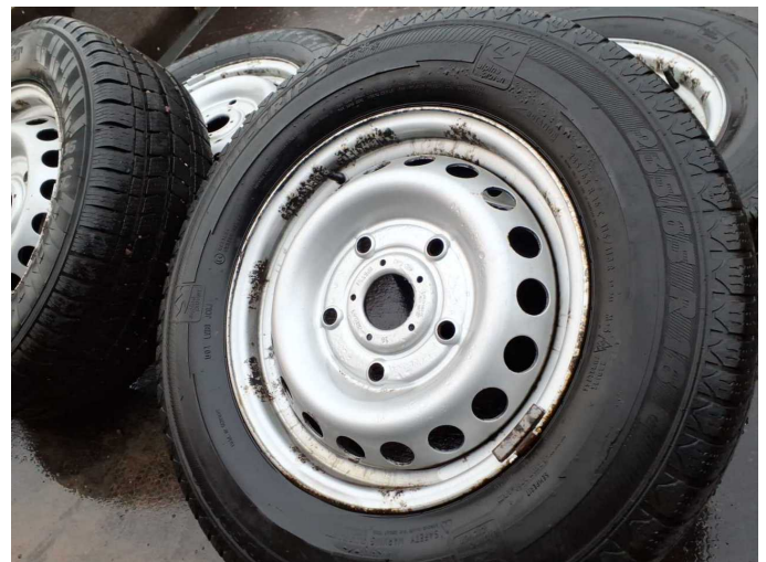
Beschädigung 14: 2.Radsatz: 2 Reifen - verschlissen - erneuern
