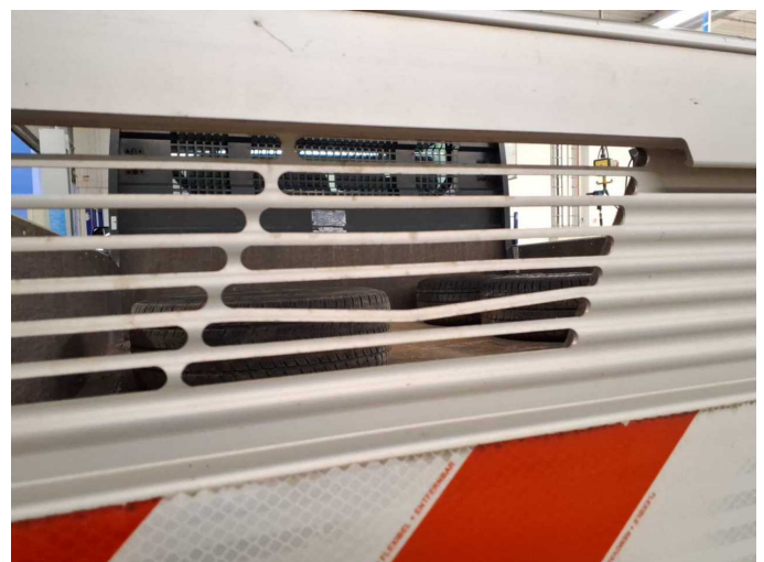
Beschädigung 21: Sonstiges: Sonstiges (Bordwandklappe hinten) - verformt - erneuern
