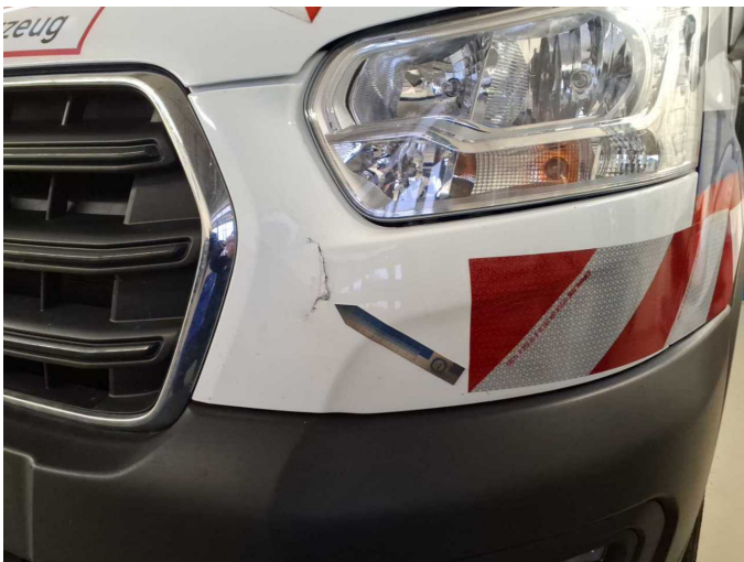
Beschädigung 20: Stossfänger vorn: Stossfänger vorn links (Oberteil) - gebrochen / gerissen - erneuern
