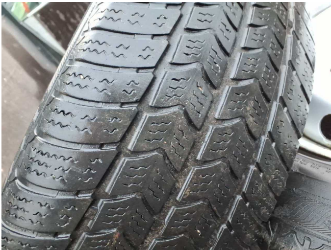
Beschädigung 14: 2.Radsatz: 2 Reifen - verschlissen - erneuern
