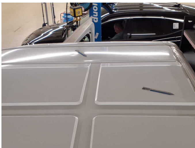
Beschädigung 19: Fahrzeugdach: Dach - Delle(n) - instandsetzen und lackieren
